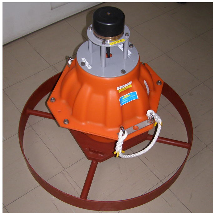
写真 1：海底に設置した海底局。上端部の黒い装置が音響送受波器。オレンジ色の容器の中に電子回路と電池が収められている。全体の高さは 80cm 弱で、重さは約 50kg。
