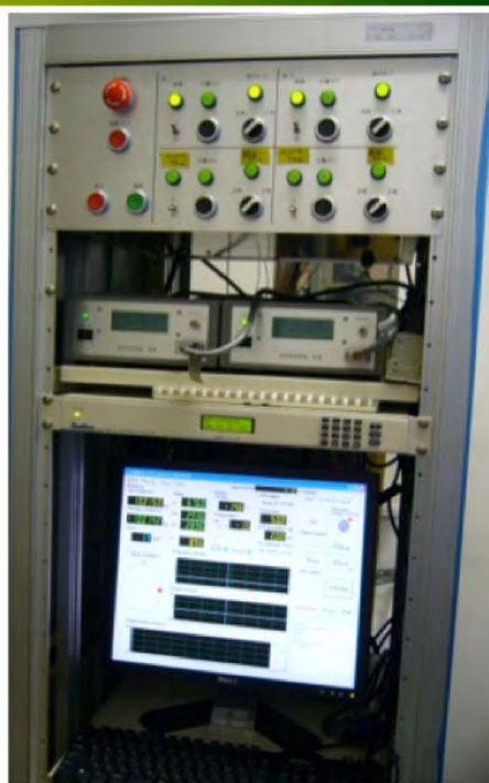
図3-16. 震源制御系。右写真は震源を制御するためのPC、GPS時計、およびパルス発生装置。左上の矢印はGPSアンテナ。左下は、車庫の中に設置した制御盤。
