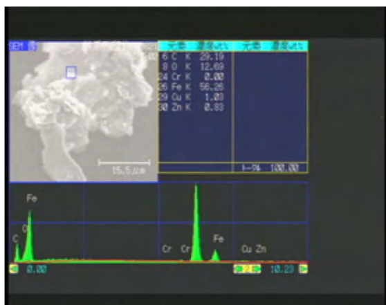
図4-18 鉄粉状金属片のSEM-EDX分析 その2（図中 □ 部分）
