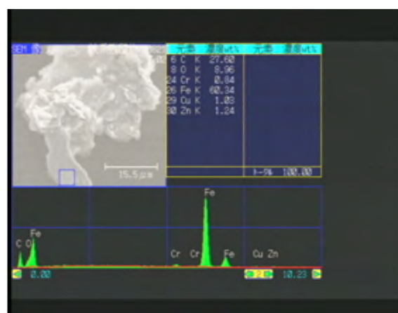
図4-17 鉄粉状金属片のSEM-EDX分析 その2（図中 □ 部分）
