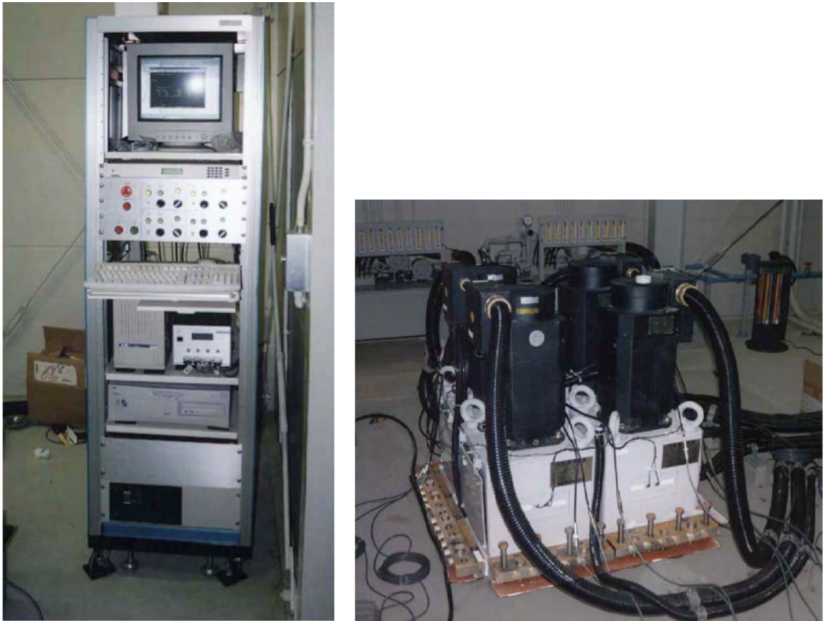
図 3-1 各務原に設置されていたときの震源装置と制御用 P C の写真
