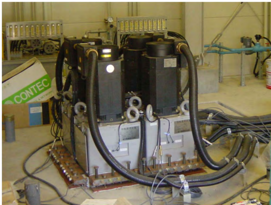
図3-8：各務原に設置されていた震源。4台を1組として震動を発生させていた。
