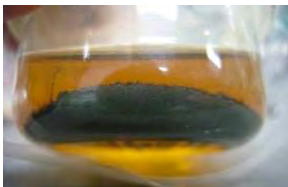
図 4-14 三河アクロスで採取された鉄粉状異物
