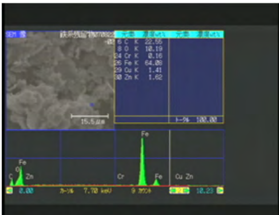
図 4-20 鉄粉状金属片の SEM-EDX 分析 その 3 (図中 □ 部分)
