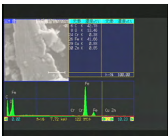
図4-16 鉄粉状金属片のSEM-EDX分析 その1
