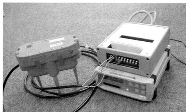
図 1. 白山工業 DATAMARK LS-7000 LS-7000 (右下) と、専用に製作したプリアンプ (右上), 物理探査用地震計 (左, 固有周波数 4.5 Hz, 3 成分).
