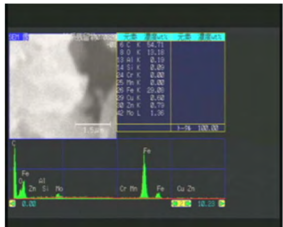
図 4-25 鉄粉状金属片の SEM-EDX 分析 その 5 (図中 □ 部分)
