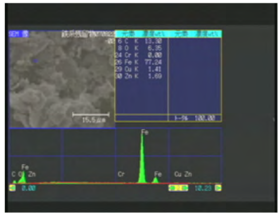
図 4-21 鉄粉状金属片の SEM-EDX 分析 その 3 (図中 □ 部分)
