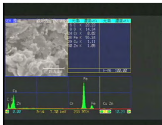
図4-19 鉄粉状金属片のSEM-EDX分析 その3
