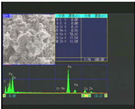
図 4-24 鉄粉状金属片の SEM-EDX 分析 その 4 (図中 □ 部分)
