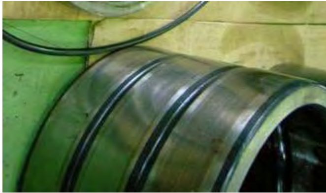
図4-27 淡路アクロスの軸受内輪（フレーキングまで至っていないもの）
