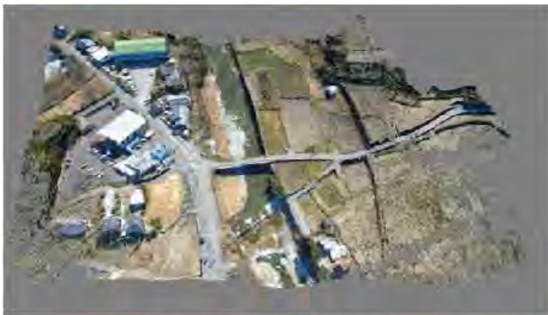
図1上 自作の小型マルチコプターにより撮影された画像から作成された地形モデル
