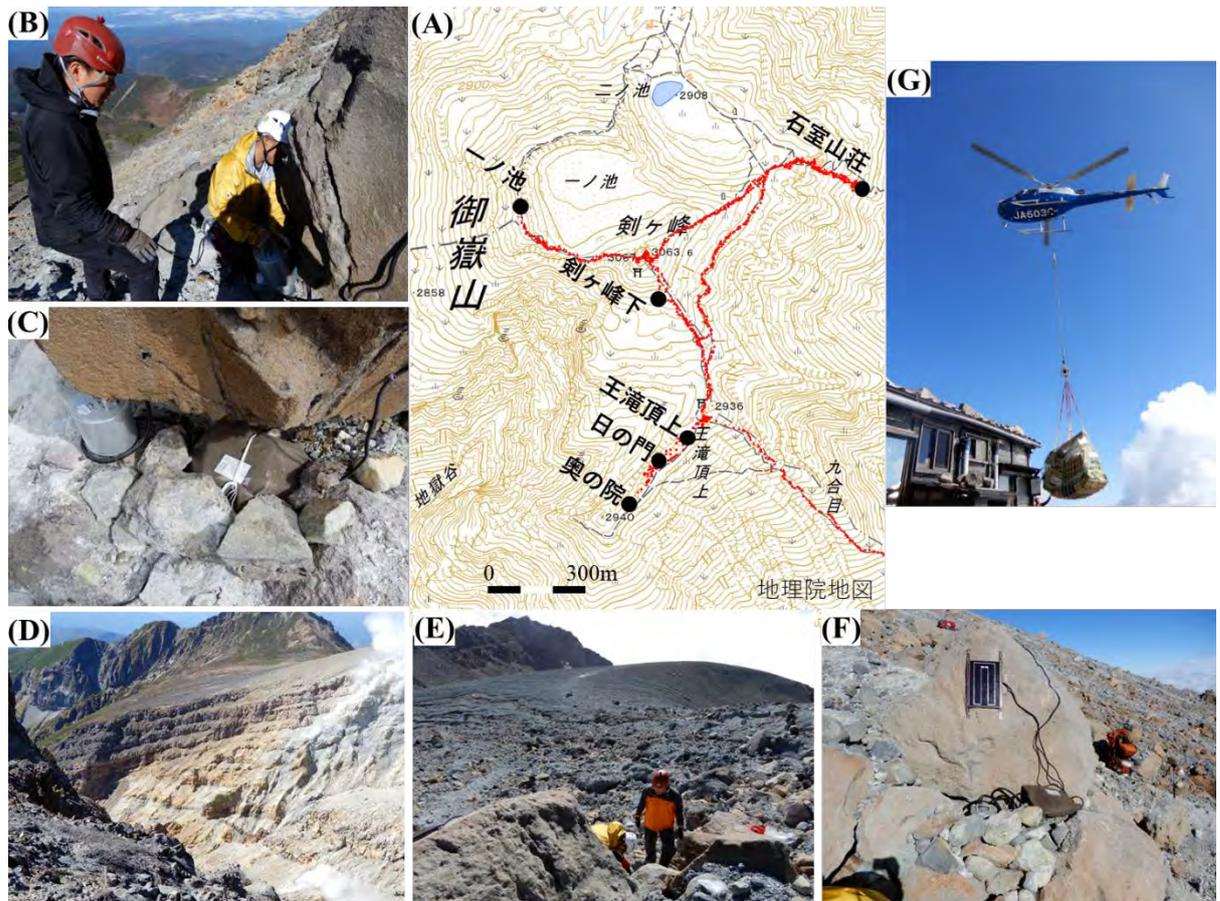
図5. (A) 2017年10月17日～19日の山頂火口地域地震観測点設置コース。黒丸が観測点。石室山荘以外の5点が規制区域内 (B) 一ノ池観測点の設置 (C) 一ノ池観測点の地震計と記録計。風にあおられたり雪で押し出されたりしないように設置後に石で囲んである (D) 地獄谷の断面。積み重なった一ノ池火山の溶岩層を見ると、成層火山の名前の由来が良く分かる (E) 剣ヶ峰観測点の設置。右奥に噴火時期不明の大きな火口が見える。(F) 剣ヶ峰観測点の地震計、記録計、太陽電池パネル (G) 石室山荘へのヘリによる荷上げ。設置場所が遠い王滝頂上以南の観測点の機材は、王滝側から人力で荷上げした。
