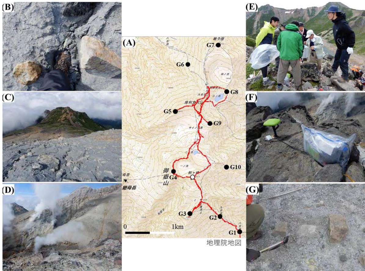
図4. (A) 2017年8月28日～30日のGNSSおよび重力観測。國友が廻ったコースのみ示した。G1～G10はGNSS観測点 (B) お鉢巡り（一ノ池火口の外輪）G4付近の火山灰の様子。登山靴が10cm以上はまる。靴底に付着する火山灰が段々と厚くなり歩きにくい (C) G4付近から見た継母岳。途中に2014年火口からの弱い噴気が見える (D) 地獄谷の2014年火口からの噴気。右上に79-7火口も見える (E) 三ノ池G8での重力測定。GNSS観測機材設置が全て完了した後、全員で巡っている (F) G3でのGNSS観測。ボルトに固定されたアンテナ：左側と観測機材：右側 (G) 剣ヶ峰で火山灰に埋まった一等三角点を発見
