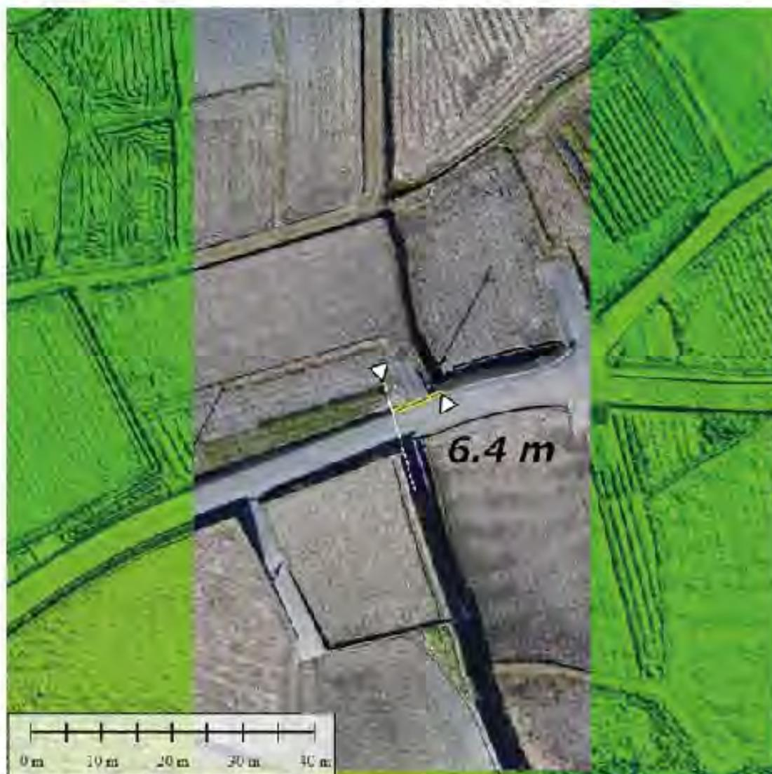
図1下 解像度 1.1 cm のオルソ画像と解像度 2.3 cm の DSM (陰影図)。段丘崖の右横ずれを GIS 上で計測した結果、6.4 m であった。
