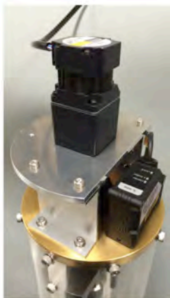
2号機上部 レーザ変位計をマウントした
