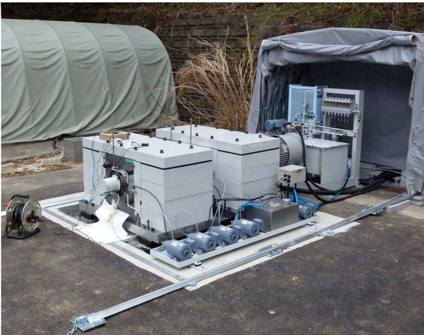
図1．第2世代アクロス震源を名古屋大学三河観測所孔内に設置したところ 第2世代アクロス震源。回転軸を水平にして遠心力で力を発生させる。写真は2台のユニットを直列に連結したところ。
